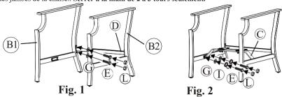
Étape 4: À ce stade, procédez à d'éventuels ajustements de l'alignement de toutes les pièces. Serrer tous les boulons de quelques tours à la fois, en alternant les boulons jusqu'à ce qu'ils soient bien serrés. Ne pas trop serrer. Un serrage excessif risque de dénuder les boulons.
